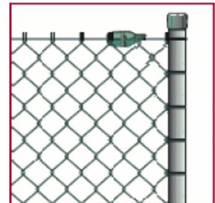
Keď bude pletivo optimálne napnuté, priviažte ho k obom krajným stĺpikom oplotenia pomocou viazacieho drôtu. Pomocou viazacieho drôtu taktiež podľa potreby priviažte pletivo k napínacím drôtom. Na konci vykonajte všetky potrebné úpravy na dosiahnutie estetického vzhľadu oplotenia.
