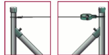
Podľa polohy napínacieho drôtu na priebežných stĺpikoch je potrebné vŕtať diery 8mm pre úchytky napínacieho drôtu. Ponastrkajte úchytky do vyvŕtaných dier, zaveste drôt na úchytky stredových stĺpikov a upevnite ho pomocou kovového háčika .
